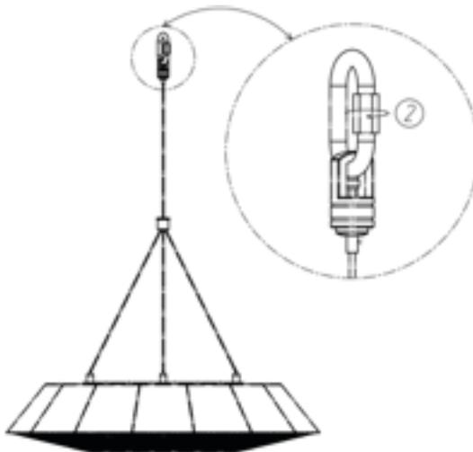
Lösen Sie die Hakenmutter in Pfeilrichtung.
