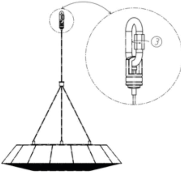
Hängen Sie den Heizstrahler ein und ziehen Sie die Mutter in Pfeilrichtung an.
